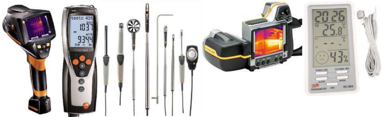
Figurë 4.2-1 a) kamera termike Testo 875i, b) sonda Testo 435, c) kamera termike Flir B360, d) termometër digjital dc-803
